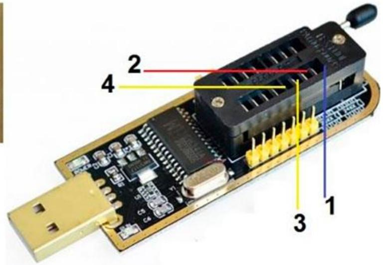
Теперь подключаем программатор к ПК и запускаем программу CH341A Programmer. В левой части окна ПО обязательно стоит указать тип, производителя и наименование чипа. Далее нажмите кнопку «Читать» на верхней панели программы.
